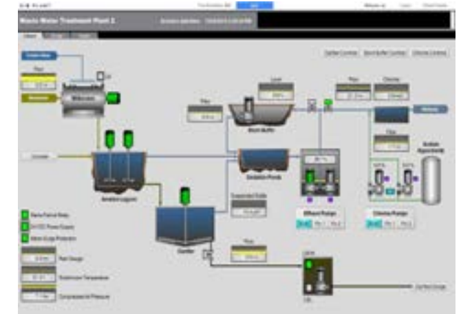
Hệ thống giám sát SCADA Nhà máy nước Bộc Nguyễn SCADA monitoring system for Boc Nguyen Water Plant
